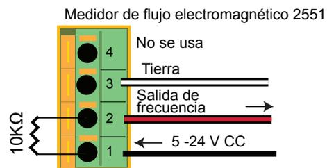
Instale una resistencia de activación cuando conecte el medidor de flujo electromagnético 2551 a los medidores de flujo de otros fabricantes.
